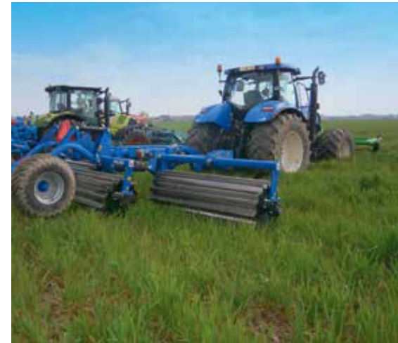
Opération de destruction mécanique du couvert hivernal
